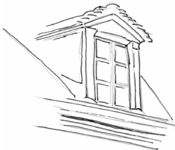
Le plâtre forme un enduit continu sur les jouées, les jambages et pignon assurant ainsi le lien avec le reste de la construction.
