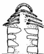
Pour rejeter les eaux de pluie, les murs peuvent être couronnés de pierres de taille. Pour les constructions plus économiques, le chaperon ou couronnement peut se réaliser en tuiles plates à un ou deux pans.
