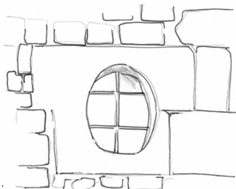
L'œil de bœuf est fréquemment utilisé dans le Vexin. Il peut être soit en pierres de taille ou percé directement dans le mur puis enduit, et le plus souvent de forme ovale. Quant à lui, le châssis d'ouverture de la fenêtre ne l'est pas nécessairement ; rectangulaire comme l'ébrasement intérieur, elle comporte un, deux ou quatre carreau(x).
